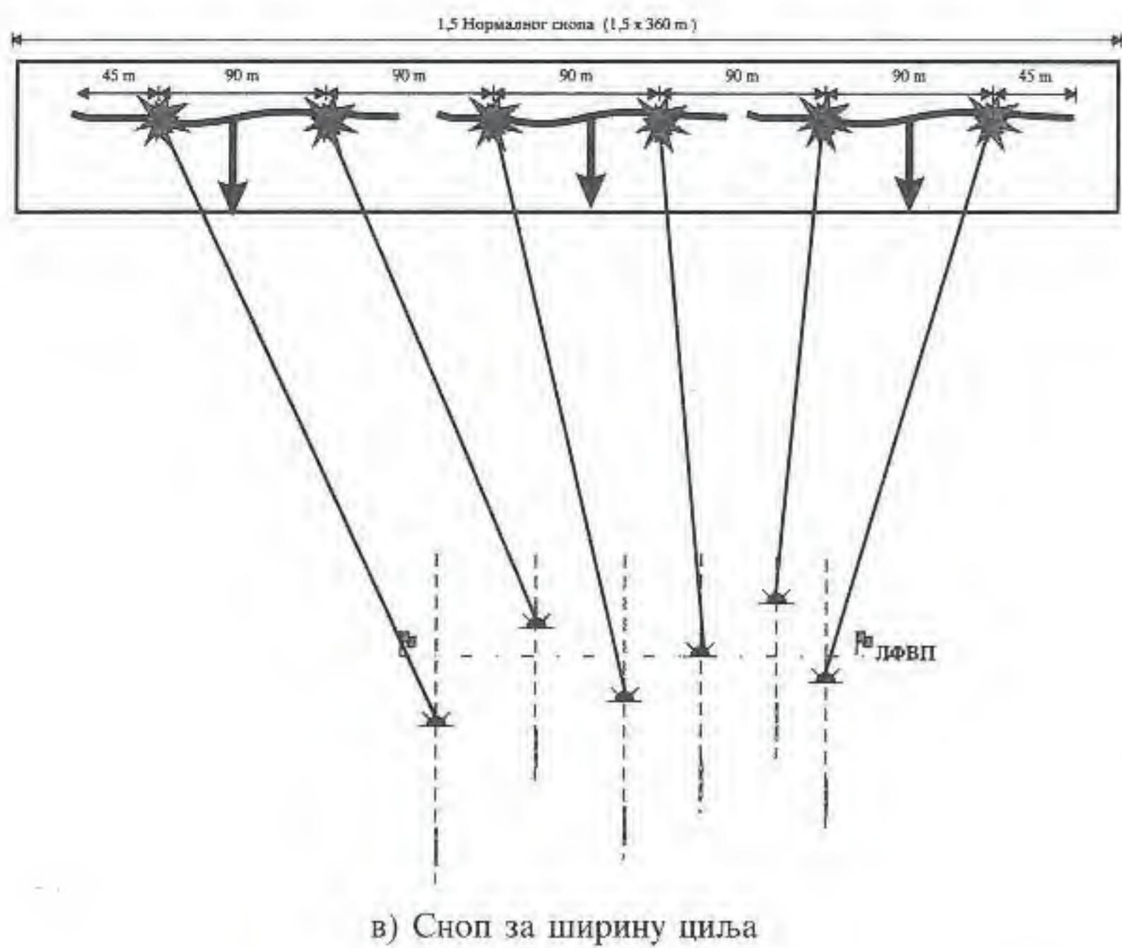
**Сноп према ширини циља** (сл. 71.в) примењује се за гађање циљева чије су ширине веће од ширине нормалног спопа (до 1,5 те ширине), или мањи (до 100 м).
